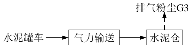
图 2.17-2 水泥进料工艺流程及产污环节图
